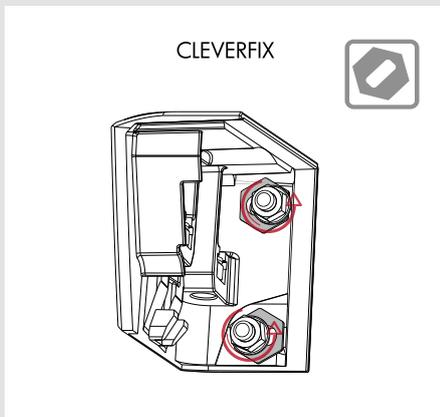
Sistema Cleverfix: flexibilidad y un margen de maniobra importante a la hora del montaje. Permite la variación de la posición de los soportes en 360° y con un margen de 20mm.
