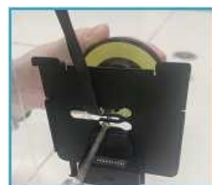
4 Alinhe a ficha da câmara com a placa de montagem
