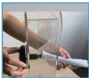
2 Coloque o cabo a atravessar a porta, de fora para dentro. (Nota: se a porta for grossa, por favor embrulhe o cabo em papel, evite parti-lo)
