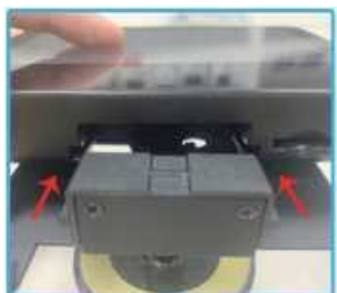
6 Alinhe o slot sob a máquina com a fivela da placa de montagem
