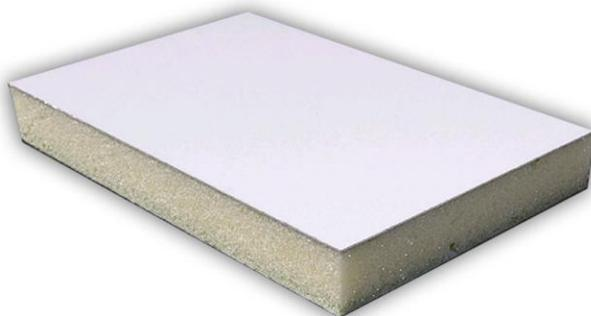
Panel sándwich formado por dos chapas de aluminio en AA3105 y núcleo de poliestireno extrusionado (XPS). Disponible en liso o con perfilado cada 85mm.
