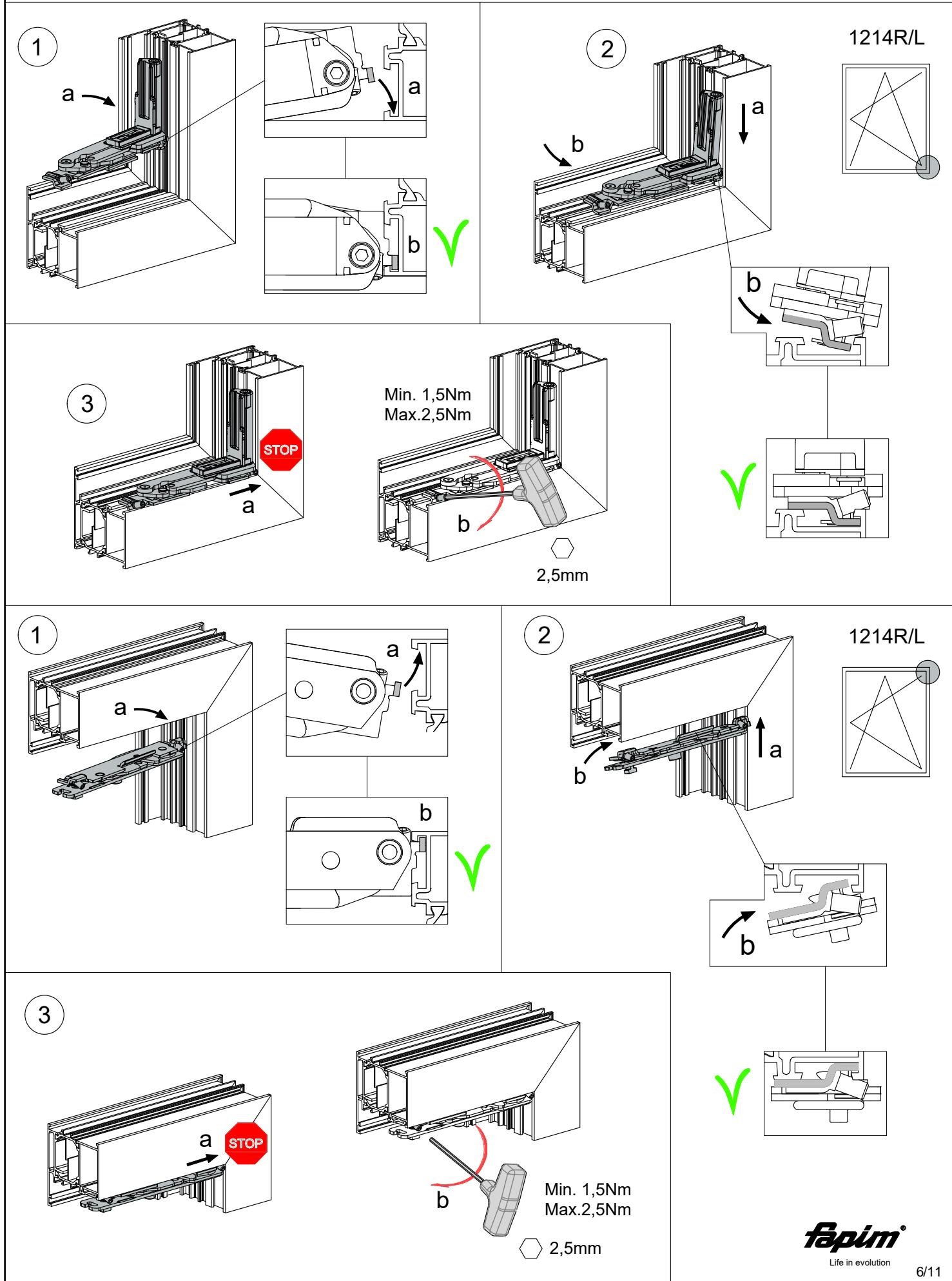
Montaggio accessori anta - Sash hardware assembly - Assemblage des accessoires de ouvrant- Montaje de accesorios de hoja
