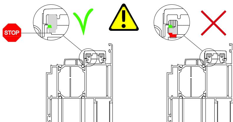
Assemblaggi anta / telaio - Sash / frame assembly - Assemblage ouvrant / dormant - Montaje hoja / marco
