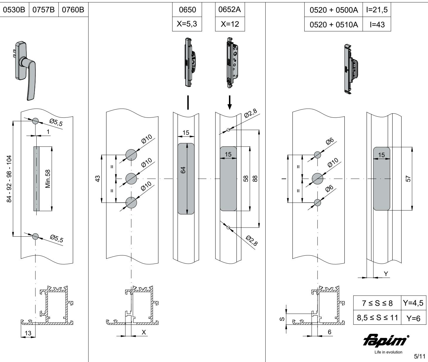
Montaggio accessori telaio - Frame hardware assembly - Assemblage des accessoires de dormant - Montaje de accesorios de marco
