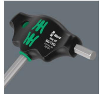
El brazo adicional corto que sale del lado del mango permite la transmisión de pares de giro extremadamente altos ya que el brazo largo es utilizado como palanca.
