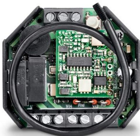
Módulo receptor para activar accionamientos de ventanas
