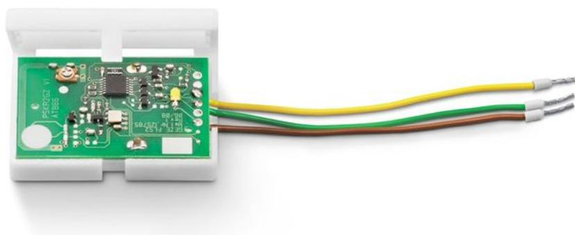
Módulo emisor para el accionamiento de las puertas automáticas GEZE y los motores para ventana mediante la conexión vía radio GEZE
