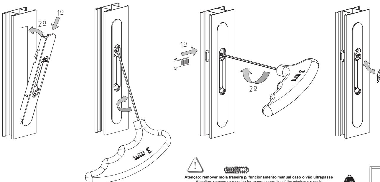
! **Atenção: remover mola traseira p/ funcionamento manual caso o vão ultrapasse 3 mm.**
