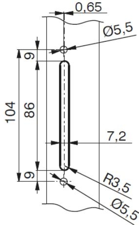
Mecanizado entre ejes: 104 mm
