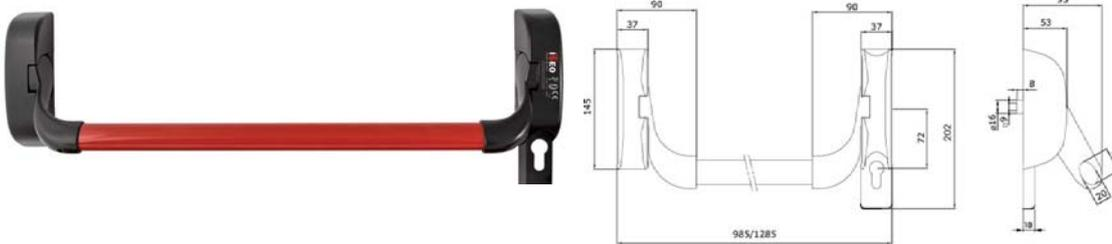
Manillón antipánico “**IDEA Base Embutir**” para **PUERTA CORTAFUEGO, PARA HOJA PRINCIPAL Y SECUNDARIA, REVERSIBLE**, adaptable a cerradura antipánico de embutir con cuadro de manilla de 9 mm. Distancia entrejees 72 mm. con rotación manilla de 30°. Plantilla. Instrucciones de montaje.
