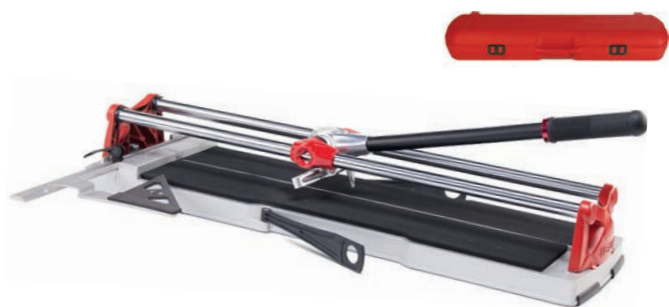
TALLADOR MANUAL PROFESSIONAL SPEED – 92 MAGNET AMB MALETA 9706677 Longitud de tall: 92 cm. Potència separador 800 kg. Màncrec reforçat amb empunyadura SOFT-GRIP. Topall lateral mil·limetrat per a talls repetitius i esquadra a 45°. Rodeta Ø 8 mm inclosa.
