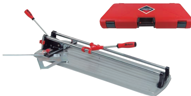
TALLADOR DE CERÀMICA TS-66 MAX GREY 9691033 Longitud de tall: 66 cm, tall diagonal 46 x 46 cm, gruix de tall 6-15 mm, separador monopunt de 800 kg de potència progressiva. Doble guia d'acer cromada. Base de grans dimensions reforçada. Topall lateral per a realitzar talls repetitius rectes i a 45°. Amb rodetes de Ø 6 i 10 mm i maleta-estoig inclosos.
